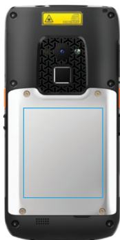
Аккумуляторная батарея (рис.9)
